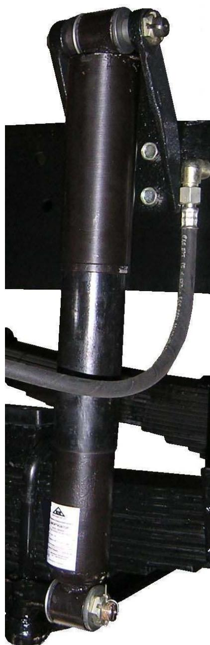
В целях исключения обрыва штока амортизатора и течи масла проведен комплекс мероприятий по совершенствованию конструкции амортизатора:
