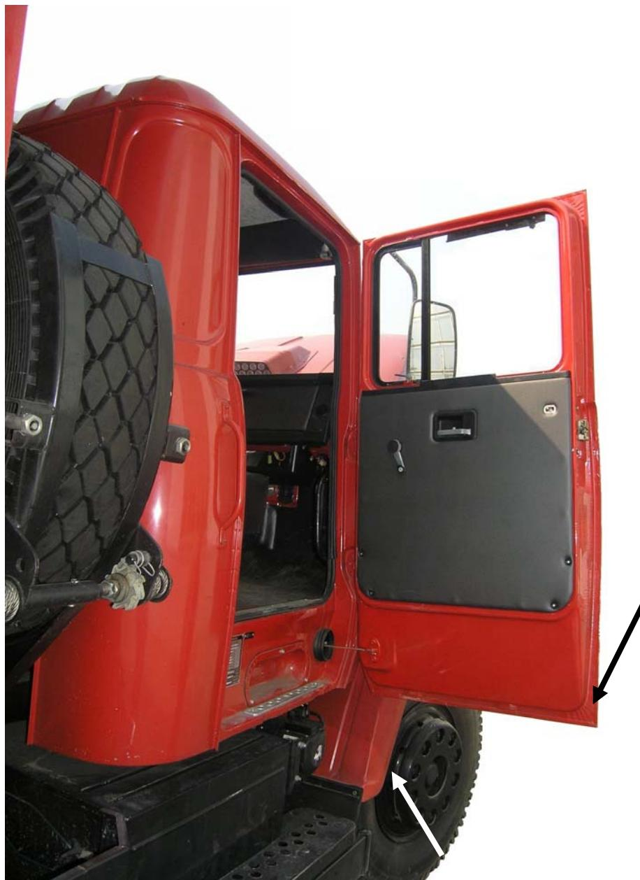
В целях защиты дверей кабины от источников образования коррозии внедрен антакоррозионный герметик на панели дверей.
