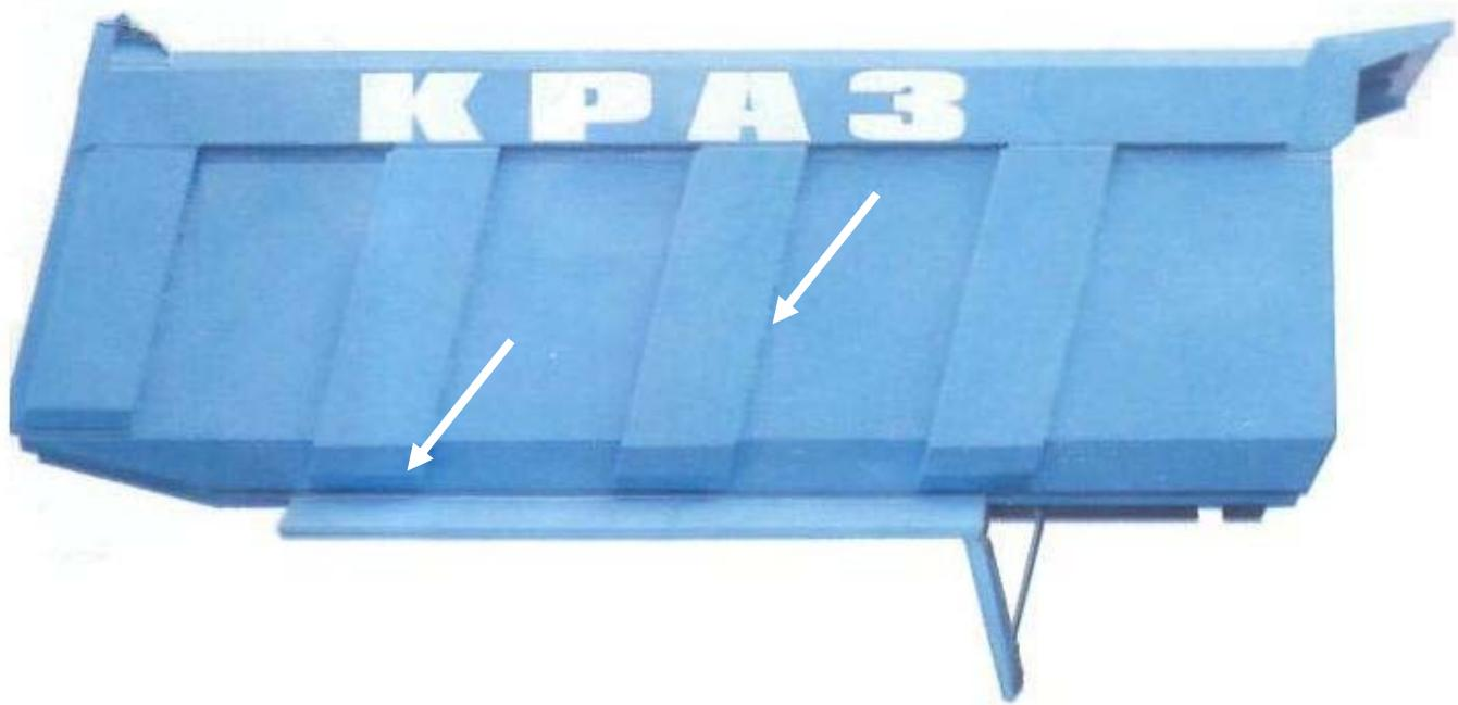
В целях обеспечения антакоррозионной защиты, подготовки поверхности под окраску, повышения качества окраски внедрена антакоррозионная обработка внутренних полостей усилителей боковых бортов самосвальных платформ антакоррозионным препаратом ML.(с 04.2008г.)
