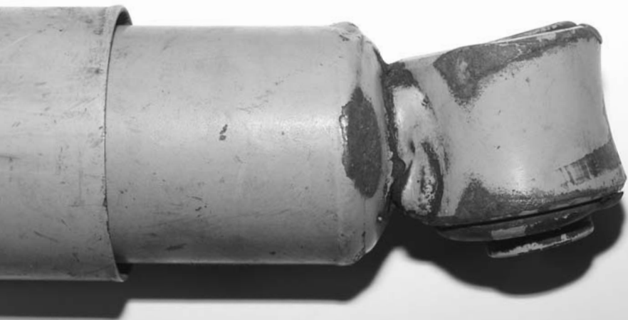
Амортизатор одного из ведущих мировых брендов не выдержал нагрузки при эксплуатации на наших дорогах и получил критичную деформацию.
