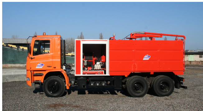
Рис. 2 Комунальний автомобіль КО-503 на шасі КрАЗ Н23.2 із мулососним та каналопромивочним обладнанням
