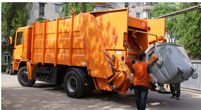
Рис. 1 Сміттєвоз КрАЗ-К12.2 із заднім завантаженням контейнерів
