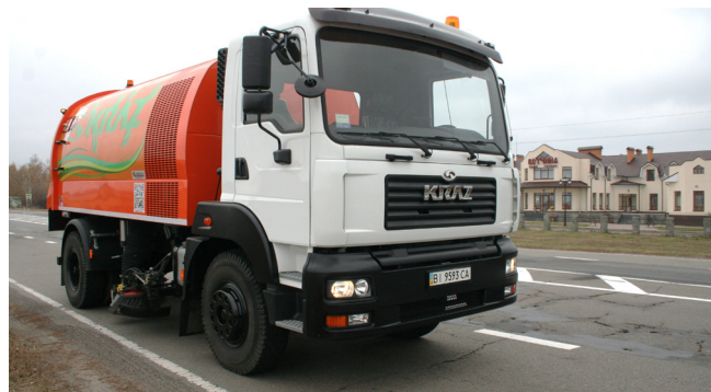
Рис. 6 Універсальний автомобіль КраЗ-5401К2 з поливомийним та піскорозкидальним обладнанням
