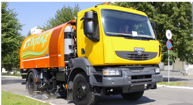
Рис. 3 Вакуумний автопилосмоктувач КраЗ-5401К2 з газовим двигуном Daimler
