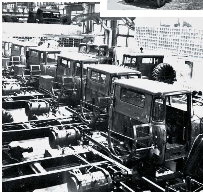
▼ Для освоения серийного выпуска цельнометаллических кабин на заводе потребовалось, по сути, заново создать штамповое и окрасочное производства
