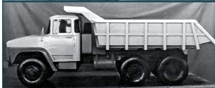
Эскиз перспективного КраЗа с цельнометаллической кабиной собственной разработки, его воплощение в виде макетов и полноразмерного опытного самосвала, изготовленного в 1967 году и получившего обозначение КраЗ-Э251А
