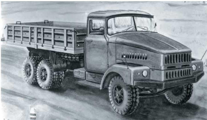
▲ Художественный рисунок и выполненный в 1962 году опытный образец самосвала КраЗ-251, у которого тоже использовали кабину от ЗИЛ-130, но капот и крылья выдержали в духе выпускавшихся тогда кременчугских грузовиков
