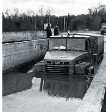
▼ Внедорожный КрАЗ-260 приняли на вооружение в 1982 году. В полу его цельнометаллической кабины сделали вырез, чтобы уместить в моторном отсеке турбонаддув, а водительское сиденье получило улучшенную амортизацию
