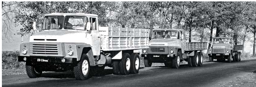
▲ Первые опытные образцы грузовиков КрАЗ-Э250. Фары еще расположены в крыльях
