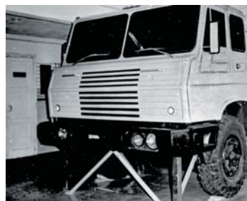
▼ Внедорожный КрАЗ-260 приняли на вооружение в 1982 году. В полу его цельнометаллической кабины сделали вырез, чтобы уместить в моторном отсеке турбонаддув, а водительское сиденье получило улучшенную амортизацию
