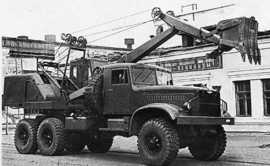
Экскаватор Э-305 на базе ЯАЗ-214 с оборудованием «обратной лопаты»
