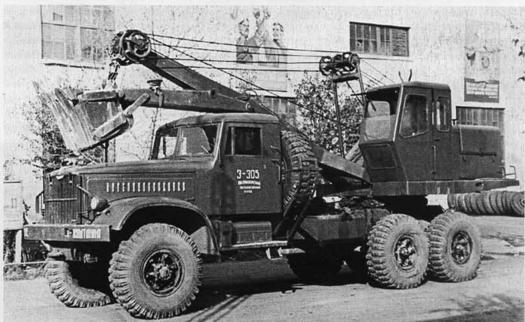
Экскаватор Э-305 на базе ЯАЗ-214 с оборудованием «прямой лопаты»
