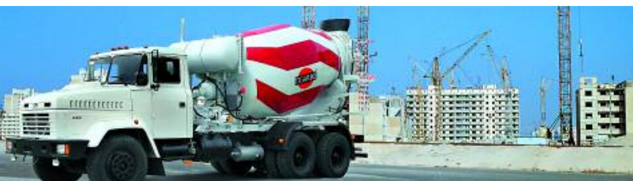
Автобетоно- смеситель КрАЗ-6333P4
