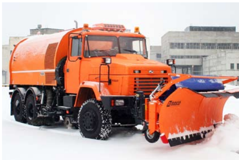
Универсальный «Дорожник» КрАЗ-63221 с подметально-уборочным оборудованием Katmer- ciler и снегоуборочным отвалом RASCO
