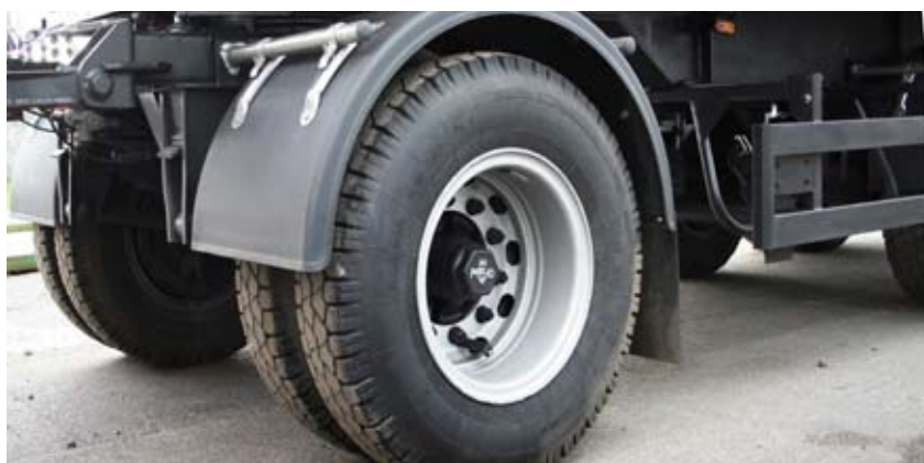
Оси Muammer Pirlanta (Турция), крылья – Eurowind (Венгрия)
