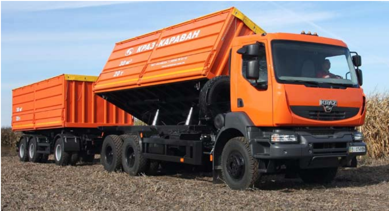
Подъем кузова осуществляется гидравлика фирмы Penta (Италия)
