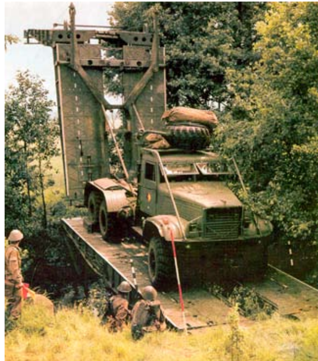
Наведение мостовой переправы с помощью тяжелого механизированного моста на базе КрАЗ-255Б
