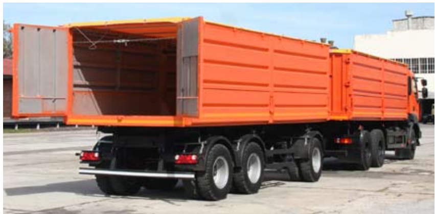
Задний борт платформы распашного типа с боковыми завесами и центральным замком
