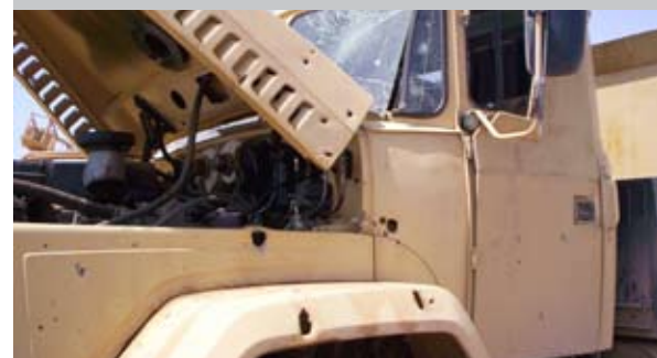
Локальное бронирование стальными листами кабины КраЗ-6322. Ирак, 2006 год
