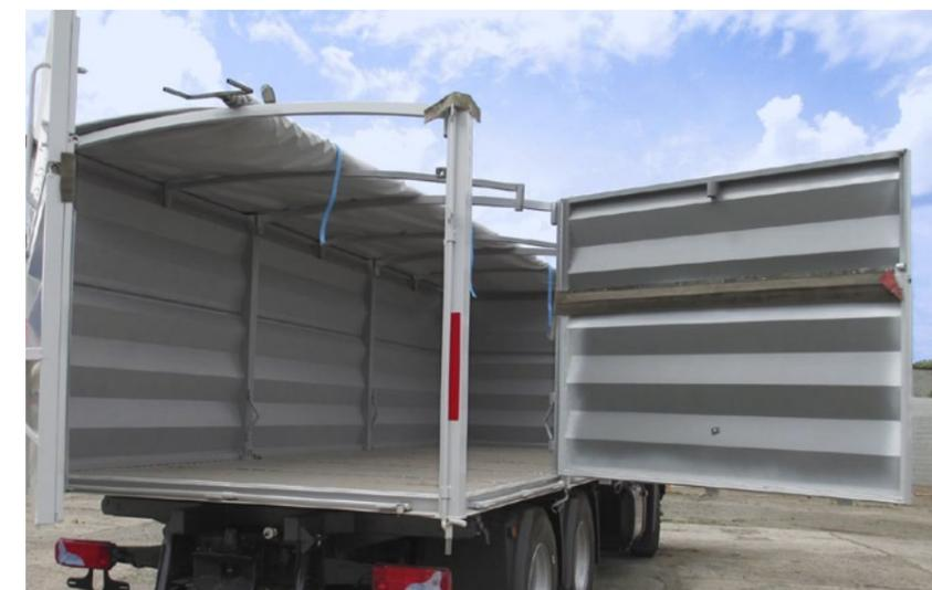
**Конструкция платформ обеспечивает самосвальную разгрузку автомобиля на правую сторону, а прицепа – на правую сторону и назад**
