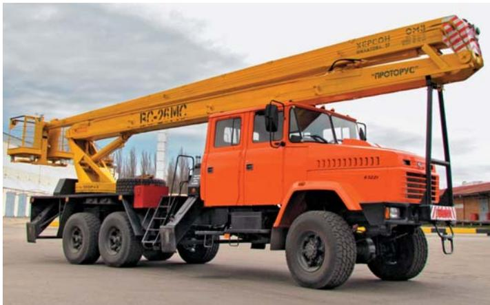
▲ Гидравлический автоподъемник ВС-26МС на полноприводном шасси КрАЗ-63221, оборудованном надстройкой производства компании «Проторус». В декабре 2013-го он был поставлен Еристовскому ГОКУ
