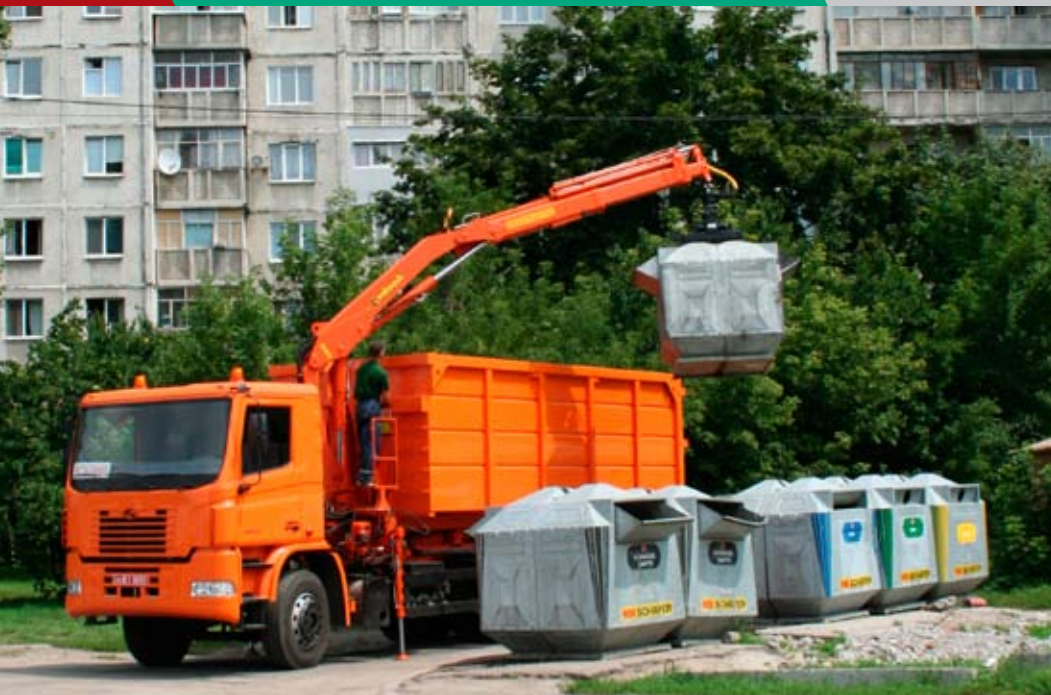
Загрузка мусора контейнерным способом автомобилем КрАЗ К16.2. Кременчуг, июль 2011 г.
