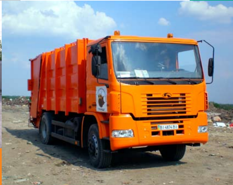
Мусоровоз КраЗ К12.2 с задней загрузкой на опытной эксплуатации в г. Донецк, июнь, 2011 г.
