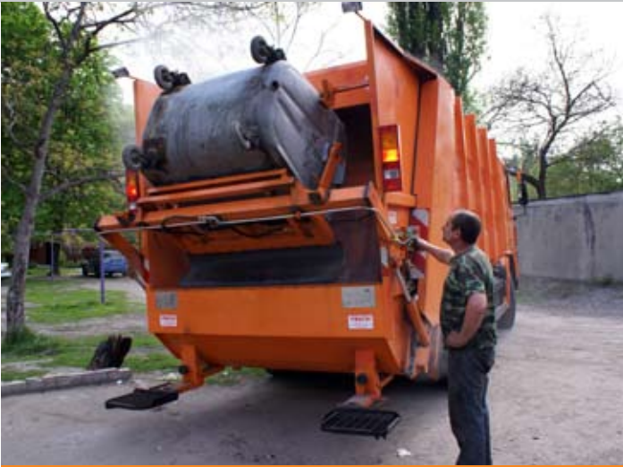
Мусоровоз КраЗ К12.2 с задней загрузкой на опытной эксплуатации в г. Донецк, июнь, 2011 г.
