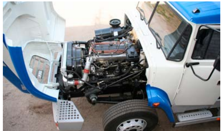
Новый двигатель ЯМЗ-6511 удобно разместился в подкапотном пространстве
