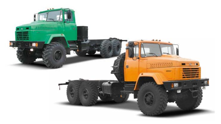
**Автомобили-шасси КрАЗ-6322** и **КрАЗ-63221** повышенной проходимости с усиленной задней подвеской предназначены для монтажа установок промышленного назначения и технологического оборудования и эксплуатации по дорогам всех категорий и бездорожью.
