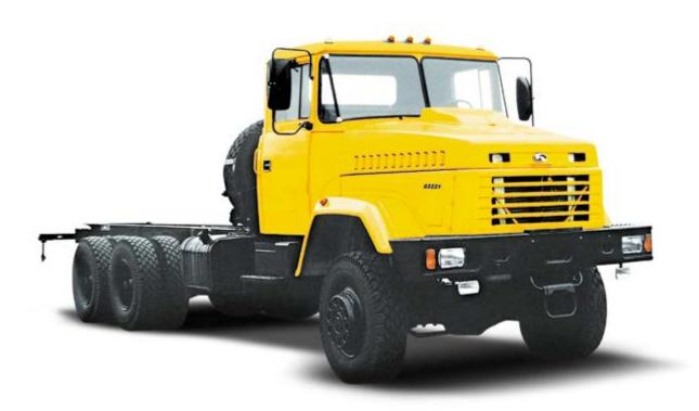
**Автомобиль-шасси КрАЗ-63221** повышенной проходимости с усиленной задней подвеской предназначен для монтажа установок промышленного назначения и технологического оборудования и эксплуатации по дорогам с твёрдым покрытием, в том числе из булыжника и щебня, а также по грунтовым дорогам.
