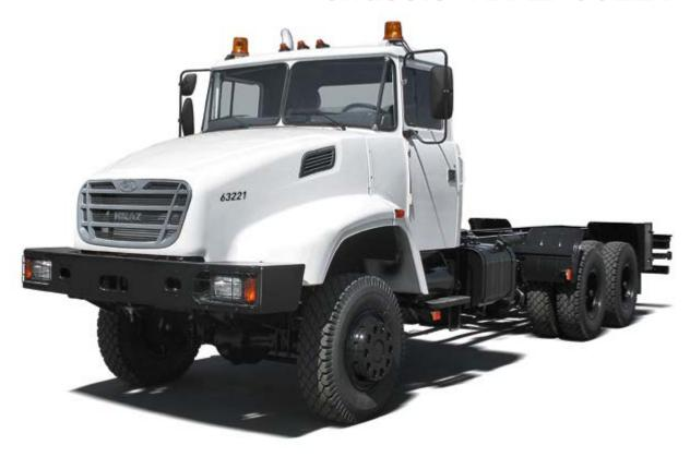
**Автомобиль-шасси КрАЗ-63221** предназначен для монтажа установок промышленного назначения и технологического оборудования и эксплуатации по дорогам с твёрдым покрытием, в том числе из булыжника и щебня, а также по грунтовым дорогам.
