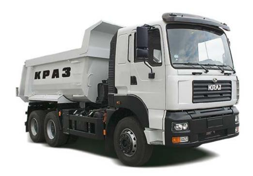
**Автомобиль-самосвал КрАЗ-6511С4** предназначен для перевозки сыпучих и навалочных грузов по дорогам с твёрдым покрытием, в том числе из булыжника и щебня.
