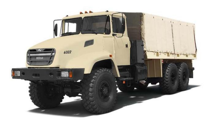
Бортовой автомобиль КрАЗ-6322 повышенной проходимости предназначен для перевозки различных грузов и людей, буксировки транспортных и специальных прицепов, а также самолётов на аэродромах. Автомобиль уверенно работает на дорогах всех категорий и бездорожье.
