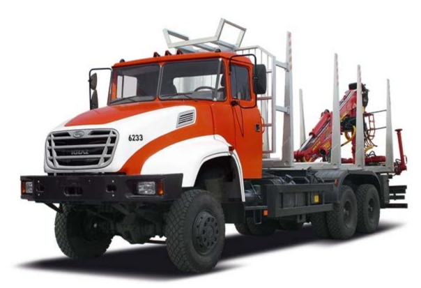
**Автомобиль-сортиментовоз КрАЗ-6233М6** предназначен для погрузки и перевозки сортиментов длиной 2, 4 и 6 метров по дорогам с твёрдым покрытием, в том числе из булыжника и щебня, а также по грунтовым дорогам.
