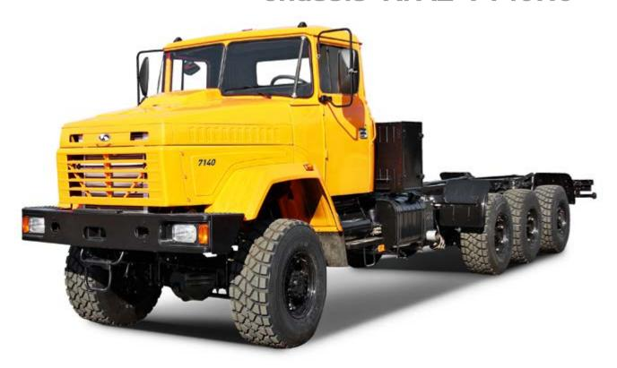
**Автомобиль-шасси КрАЗ-7140Н6** повышенной проходимости предназначен для монтажа установок промышленного назначения и технологического оборудования и эксплуатации по дорогам всех категорий и бездорожью.
