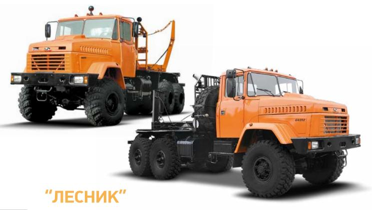
**Автомобиль лесовозный тягач КрАЗ-64372** повышенной проходимости предназначен для перевозки хлыстов и деревьев в составе автопоезда с прицепом-роспуском по дорогам всех категорий и бездорожью.
