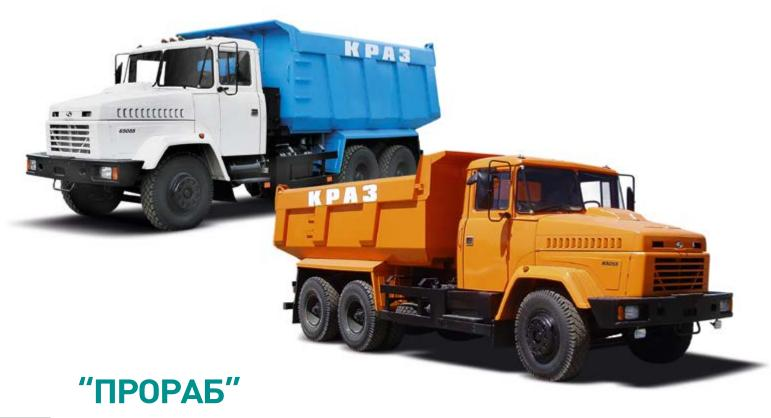
**Автомобиль-самосвал КрА3-65055** предназначен для перевозки сыпучих и навалочных грузов по дорогам с твердым покрытием, в том числе из булыжника и щебня, а также по грунтовым дорогам.
