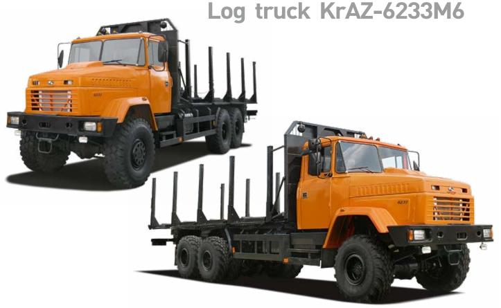
**Автомобиль-сортиментовоз КрА3-6233М6** предназначен для погрузки и перевозки сортиментов длиной 2, 4 и 6 метров по дорогам всех категорий и бездорожью.
