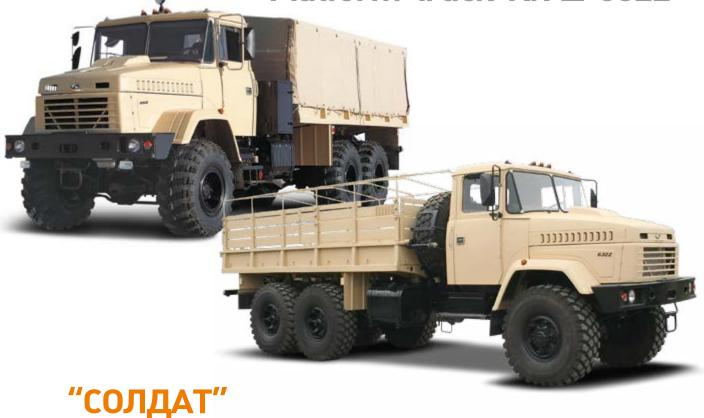
Бортовой автомобиль КрАЗ-6322 повышенной проходимости предназна-чен для перевозки различных грузов и людей, буксировки транспортных и специальных прицепов, а также самолётов на аэродромах. Автомобиль уверенно работает на дорогах всех категорий и бездорожье.
