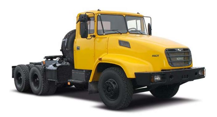
**Автомобиль-тягач седельный КрАЗ-64431** предназначен для буксировки полуприцепов по дорогам общей сети.
