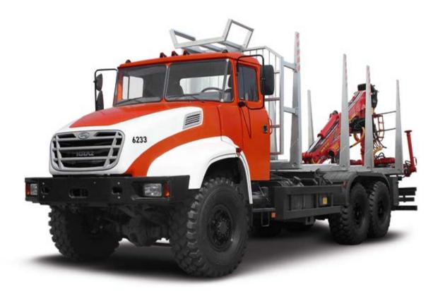
**Автомобиль-сортиментовоз КрАЗ-6233М6** предназначен для погрузки и перевозки сортиментов длиной 2, 4 и 6 метров по дорогам всех категорий и бездорожью.
