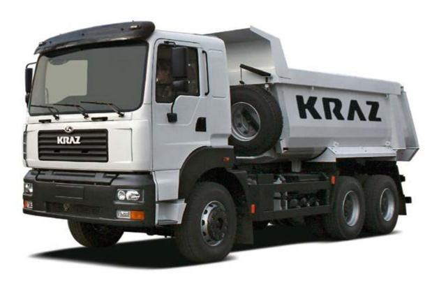
**Автомобиль-самосвал КрАЗ-7511С4** предназначен для перевозки сыпучих и навалочных грузов по дорогам с твёрдым покрытием, в том числе из булыжника и щебня, а также по грунтовым дорогам.
