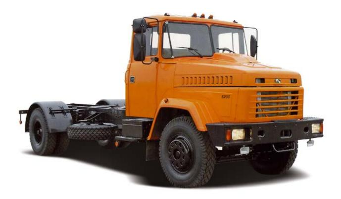
**Автомобиль-шасси КрАЗ-5233Н2** предназначен для монтажа установок промышленного назначения и технологического оборудования и эксплуатации по дорогам с твёрдым покрытием, в том числе из булыжника и щебня, а также по грунтовым дорогам.
