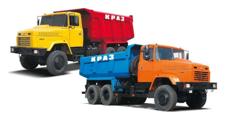
**Автомобиль-самосвал КрАЗ-65032** с усиленной задней подвеской предназначен для перевозки строительных сыпучих и навалочных грузов по дорогам с твёрдым покрытием, в том числе из булыжника и щебня, а также по грунтовым дорогам.
