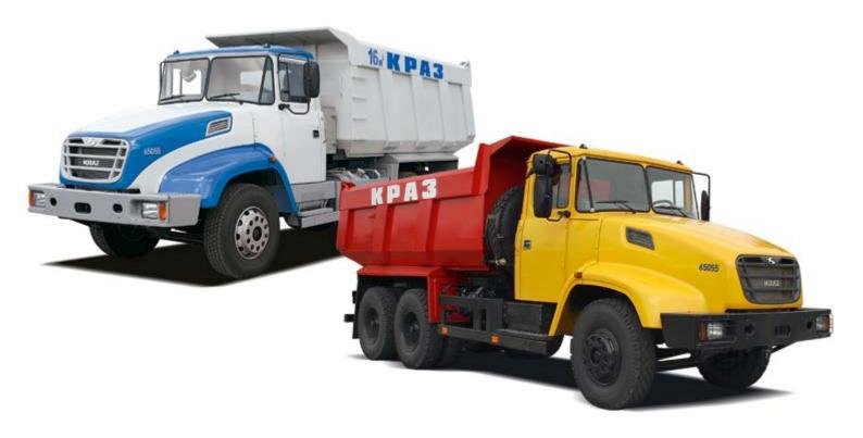
**Автомобиль-самосвал КрАЗ-65055** предназначен для перевозки сыпучих и навалочных грузов по дорогам с твёрдым покрытием, в том числе из булыжника и щебня, а также по грунтовым дорогам. Оборудован капотом интегрального типа.
