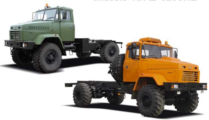
**Автомобиль-шасси КрАЗ-5233НЕ** повышенной проходимости предназначен для монтажа установок промышленного назначения, а также специальных надстроек с технологическим оборудованием, используемых для ликвидации аварий, пожаров, других техногенных и природных бедствий, доставки людей и модулей жизнеобеспечения в условиях труднопроходимой местности.
