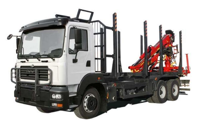
**Автомобиль-сортиментовоз КрАЗ-6511М4** предназначен для погрузки и перевозки сортиментов длиной 2, 4 и 6 метров по дорогам с твёрдым покрытием, в том числе из булыжника и щебня, а также по грунтовым дорогам.
