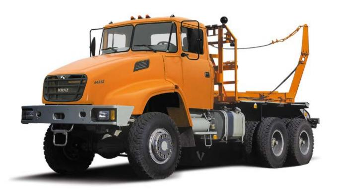
**Автомобиль лесовозный тягач КрАЗ-64372** предназначен для перевозки хлыстов и деревьев в составе автопоезда с прицепом-роспуском по дорогам с твёрдым покрытием, в том числе из булыжника и щебня, а также по грунтовым дорогам.
