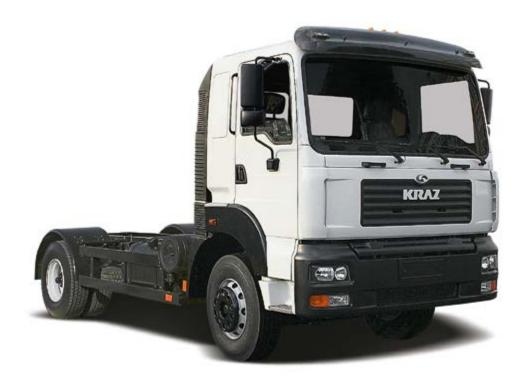
**Автомобиль-шасси КрА3-5401Н2** предназначен для монтажа установок промышленного назначения и технологического оборудования и эксплуатации по дорогам с твёрдым покрытием, в том числе из булыжника и щебня.
