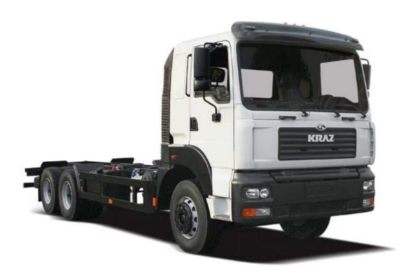
**Автомобиль-шасси КрАЗ-6511Н4** предназначен для монтажа установок промышленного назначения и технологического оборудования и эксплуатации по дорогам с твёрдым покрытием, в том числе из булыжника и щебня, а также по грунтовым дорогам.
