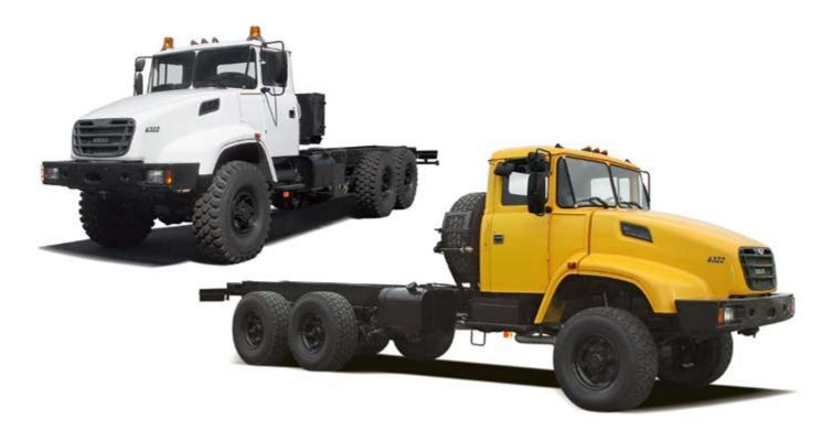
**Автомобили-шасси КрАЗ-6322; КрАЗ-63221** повышенной проходимости предназначены для монтажа установок промышленного назначения и технологического оборудования и эксплуатации по дорогам всех категорий и бездорожью.
