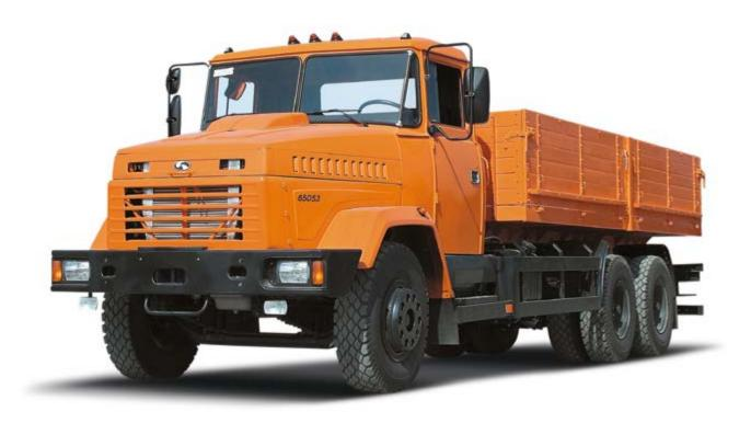
**Бортовой автомобиль КрАЗ-65053** предназначен для перевозки различных грузов и эксплуатации по дорогам с твёрдым покрытием, в том числе из булыжника и щебня, а также по грунтовым дорогам.
