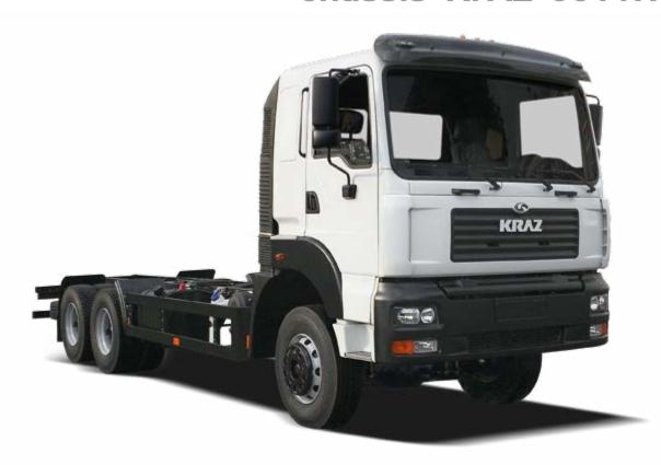
**Автомобили-шасси КрАЗ-6511Н6** предназначены для монтажа установок промышленного назначения и технологического оборудования и эксплуатации по дорогам с твёрдым покрытием, в том числе из булыжника и щебня, а также по грунтовым дорогам.
