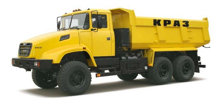
**Автомобиль-самосвал КрА3-65032** повышенной проходимости предназначен для перевозки строительных сыпучих и навалочных грузов по дорогам всех категорий и бездорожью.
