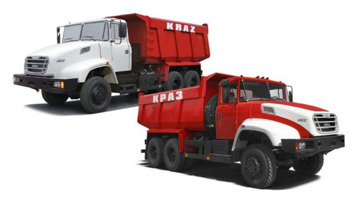
**Автомобиль-самосвал КрА3-65032** повышенной проходимости предназначен для перевозки строительных сыпучих и навалочных грузов по дорогам с твёрдым покрытием, в том числе из булыжника и щебня, а также по грунтовым дорогам.
