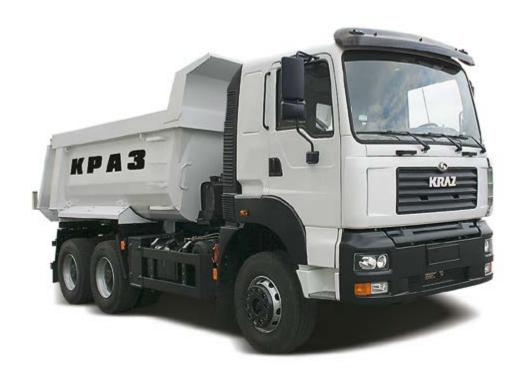
**Автомобиль-самосвал КрАЗ-6511С6** предназначен для перевозки сыпучих и навалочных грузов по дорогам с твёрдым покрытием, в том числе из булыжника и щебня.
