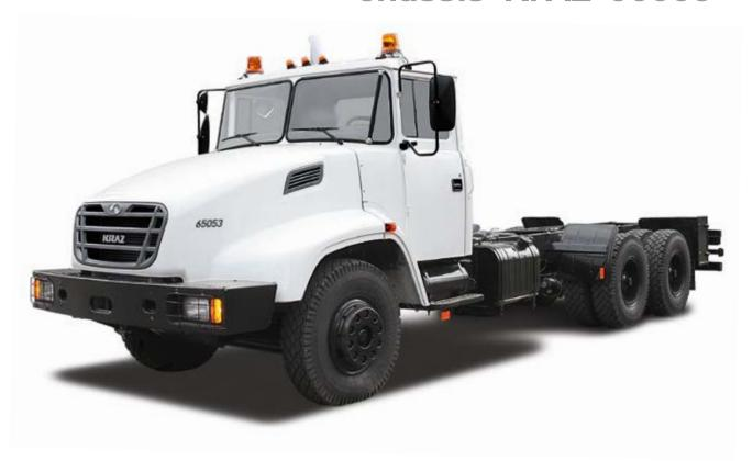
**Автомобиль-шасси KrAZ-65053** предназначен для монтажа различных установок и эксплуатации по дорогам с твёрдым покрытием, в том числе из булыжника и щебня, а также по грунтовым дорогам.
