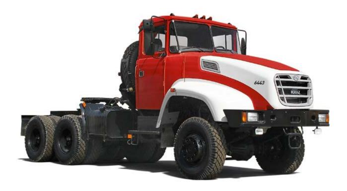
**Автомобиль-тягач седельный КрАЗ-6443** предназначен для буксировки полуприцепов-тяжеловозов по дорогам с твёрдым покрытием, в том числе из булыжника и щебня, а также по грунтовым дорогам.
