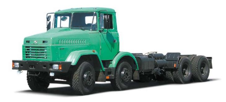
**Автомобиль-шасси КрАЗ-7133Н4** предназначен для монтажа установок промышленного назначения и технологического оборудования и эксплуатации по дорогам с твёрдым покрытием, в том числе из булыжника и щебня, а также по грунтовым дорогам.
