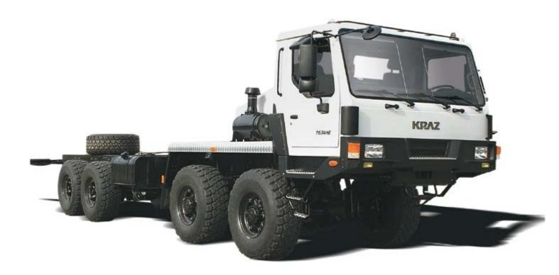
**Шасси специальное КрА3-7634НЕ** компоновки «кабина перед двигателем» предназначено для монтажа различных установок и технологического оборудования и может эксплуатироваться по всем видам дорог и бездорожью.
