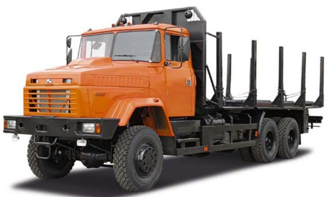
**Автомобиль-сортиментовоз КрАЗ-6233М6** предназначен для погрузки и перевозки сортиментов длиной 2, 4 и 6 метров по дорогам с твёрдым покрытием, в том числе из булыжника и щебня, а также по грунтовым дорогам.
