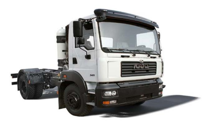
**Автомобиль-шасси КрАЗ-5401Н2** предназначен для монтажа установок промышленного назначения и технологического оборудования и эксплуатации по дорогам с твёрдым покрытием, в том числе из булыжника и щебня.
