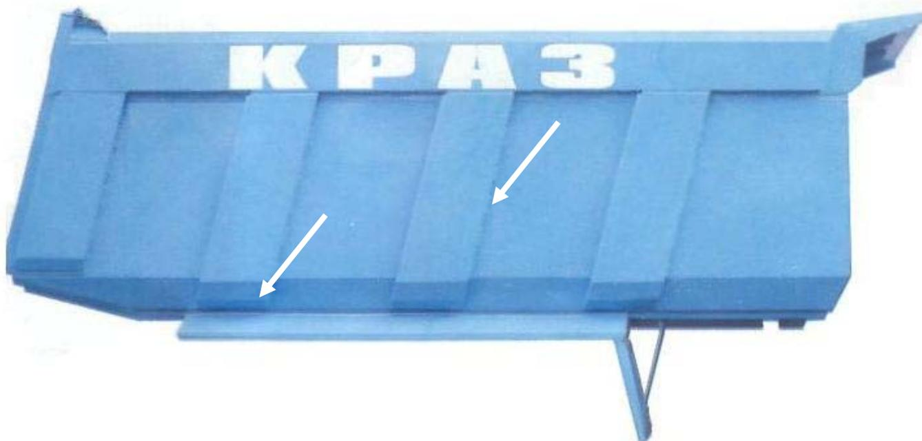
В целях обеспечения антикоррозионной защиты, подготовки поверхности под окраску, повышения качества окраски внедрена антикоррозионная обработка внутренних полостей усилителей боковых бортов самосвальных платформ антикоррозионным препаратом ML.(с 04.2008г.)
