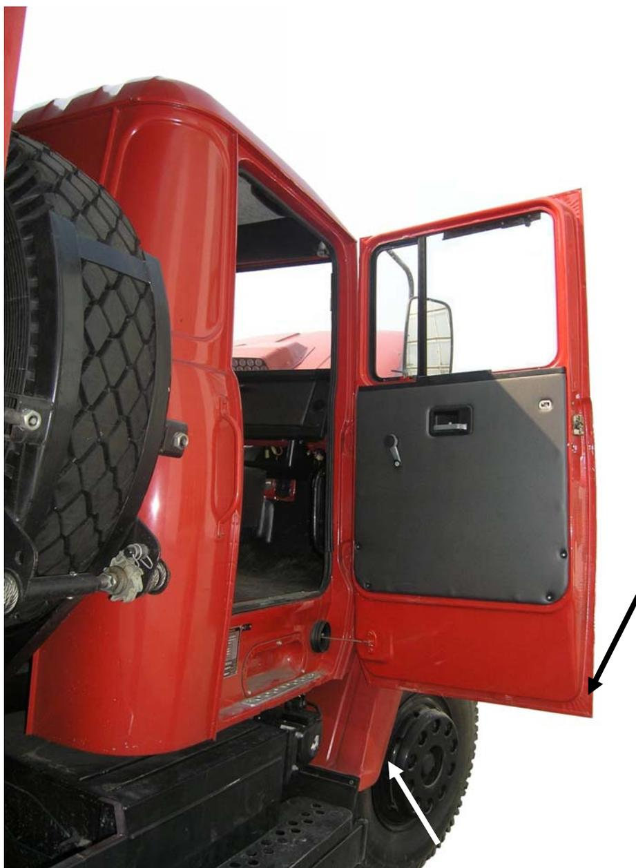
В целях защиты дверей кабины от источников образования коррозии внедрен антикоррозионный герметик на панели дверей.
