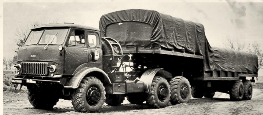
Тягач КраЗ-259Б с отбором мощности на активный полуприцеп 834Б (1962 г.): грузоподъемность — 15 т, расход топлива — 68 л/100 км
