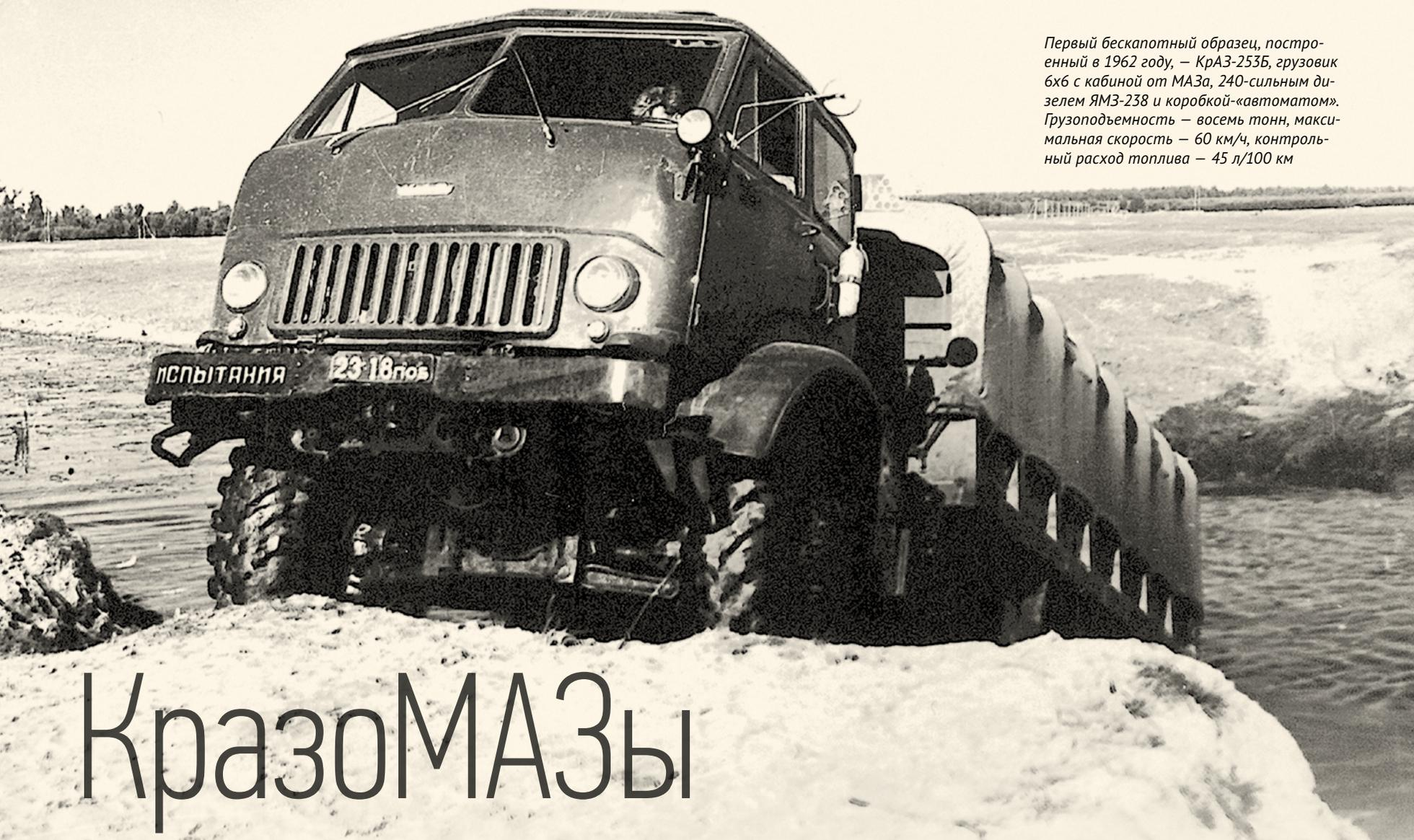
Первый бескапотный образец, построенный в 1962 году, — КраЗ-253Б, грузовик 6х6 с кабиной от МАЗа, 240-сильным дизелем ЯМЗ-238 и коробкой-«автоматом». Грузоподъемность — восемь тонн, максимальная скорость — 60 км/ч, контрольный расход топлива — 45 л/100 км
