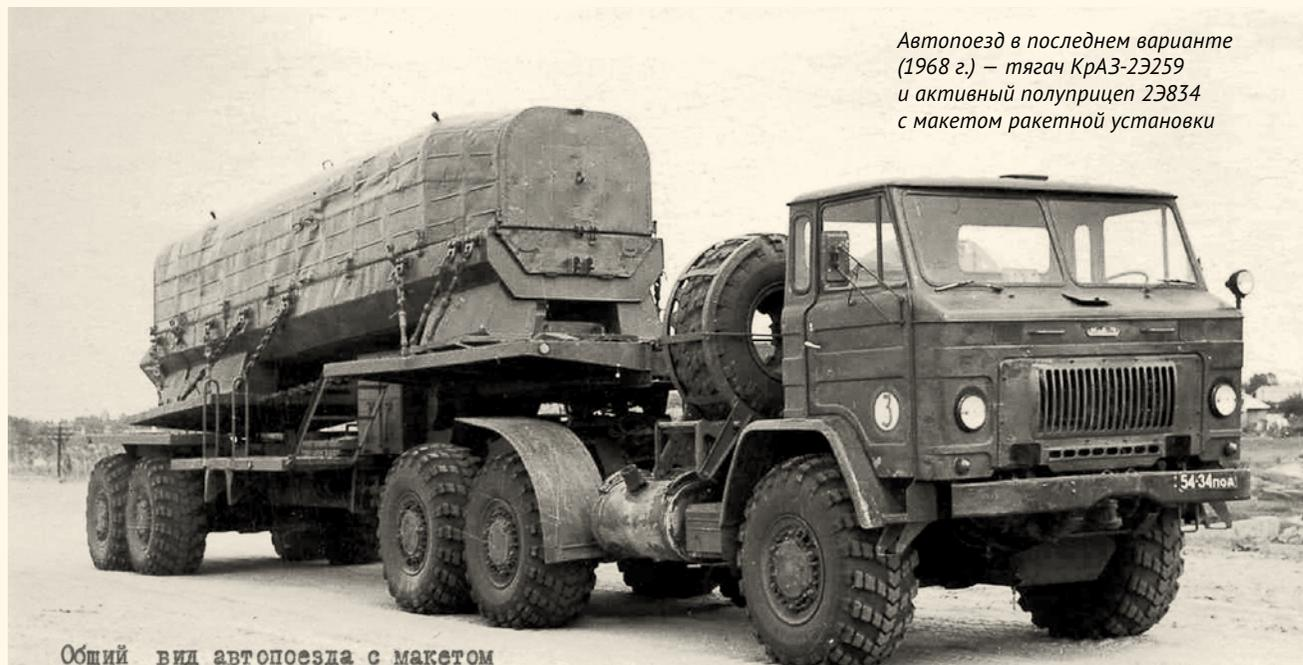
Автопоезд в последнем варианте (1968 г.) — тягач КраЗ-25259 и активный полуприцеп Э834 с макетом ракетной установки
