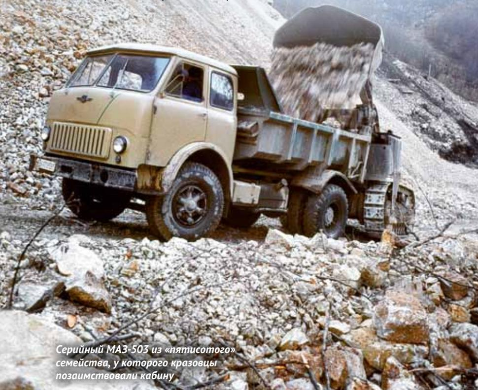
Серийный МАЗ-503 из «пятисотого» семейства, у которого кразовцы позаимствовали кабину
