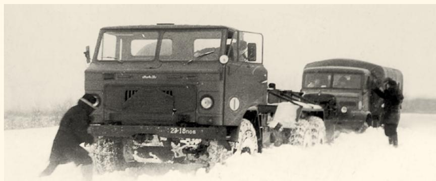
Испытания в глубоком снегу: бескапотный КраЗ вытаскивает носатого собрата
