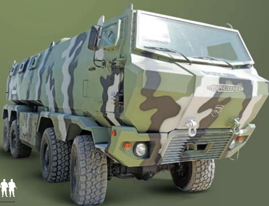
**Противоминная защита.** Уровень 2a и 2b STANAG 4569 определяет, что машина должна выдерживать подрыв мины (6 кг в тротиловом эквиваленте) под любым из колес или под днищем автомобиля без угрозы для десанта и экипажа. Машина также имеет высокий уровень противоминной защиты, характерный для машин класса MRAP, днище бронекорпуса – V-образное.
