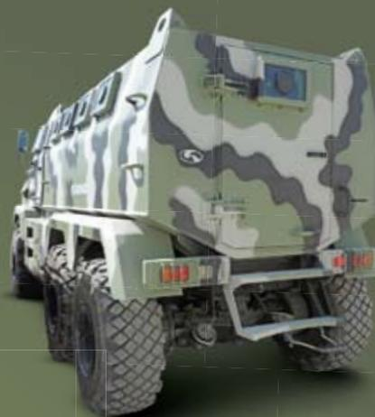
Машина имеет широко распространенную для машин MRAP капотную компоновку. Силовая установка состоит из 380-сильного дизельного двигателя Cummins ISME 385 с турбонаддувом, и шестисторонней автоматической трансмиссии Allison 400.
