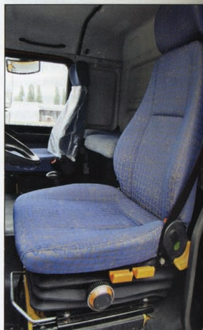
Жесткость подрессоренного кресла можно регулировать в зависимости от веса водителя.
