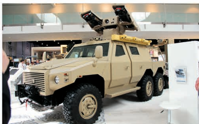
...и трехосные. На снимке — противотанковое исполнение с ПТУР и динамической защитой от РПГ
