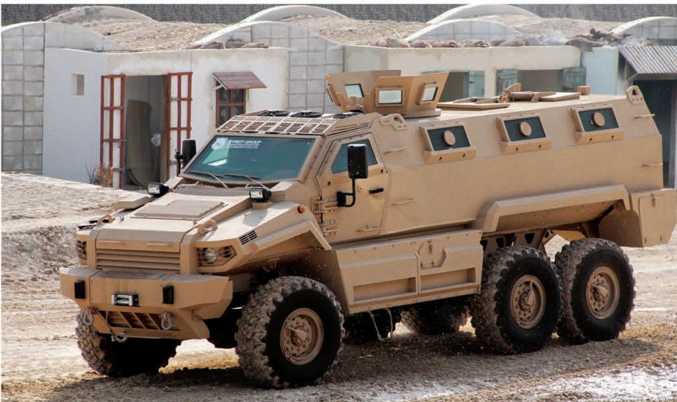
Трехосный вариант броневедомоля Streit Typhoon . Ведущие мосты — от КАМАЗа!
