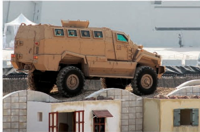
Streit Typhoon с мостами от КАМАЗа: двигатель — Cummins (300 или 400 л.с.), КП — «автомат» Allison, экипаж — 10—12 человек, полная масса — до 16 т
