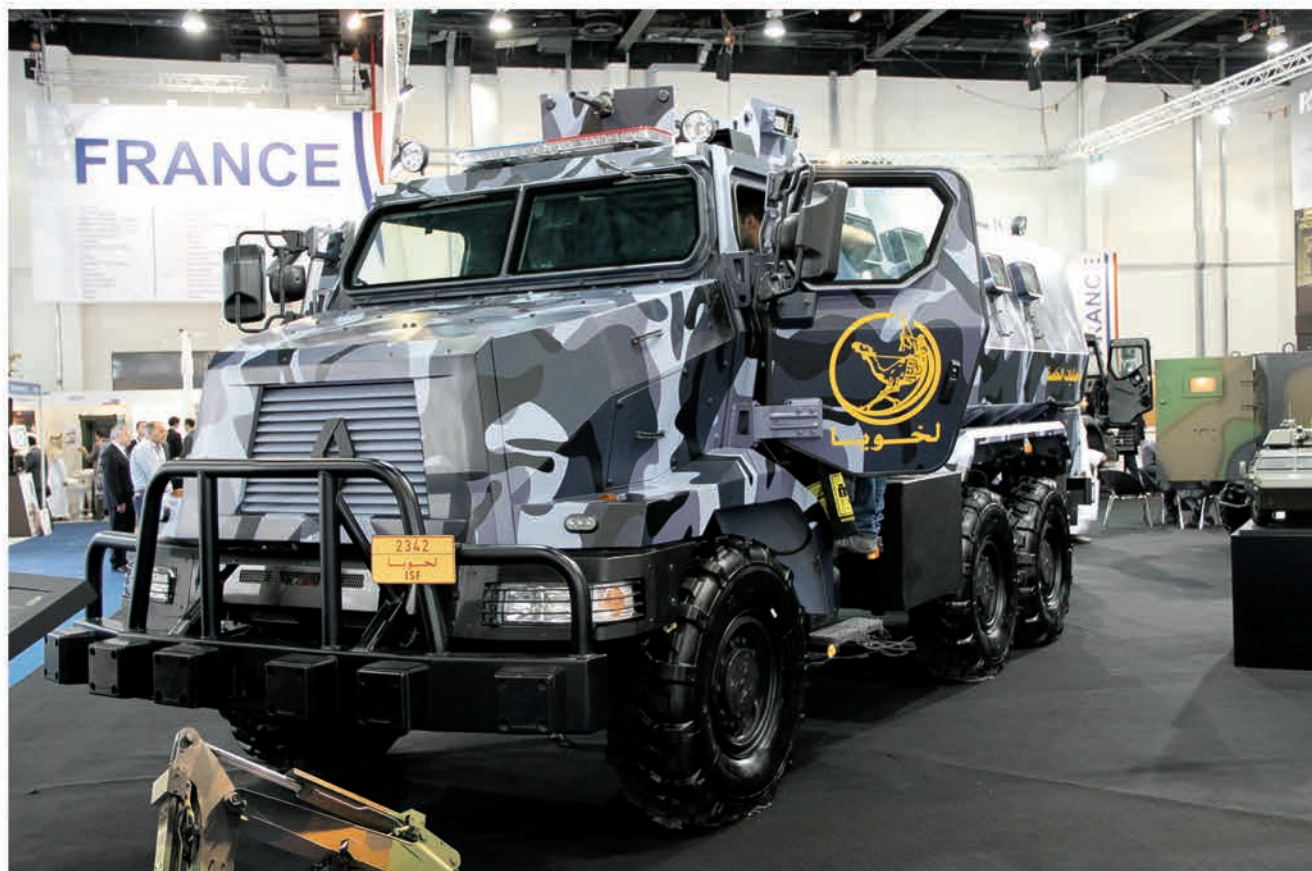
Французский Renault Higuard — 20-тонный «противоминный» бронегрузовик по заказу Ливана
