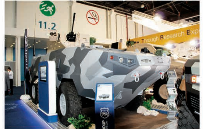
Бронетранспортер Streit Veran 6x6 построен на тех же агрегатах, что и Typhoon , но бронирован мощнее: от подрыва — по четвертому уровню STANAG
