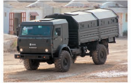
В поезде участвовал и обычный КАМАЗ, защищенный компанией Streit Group — с кабиной, сваренной из бронестали
