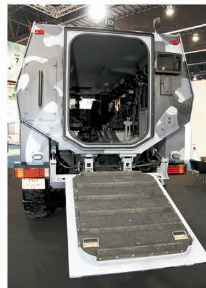
Французский Renault Higuard — 20-тонный «противоминный» бронегрузовик по заказу Ливана
