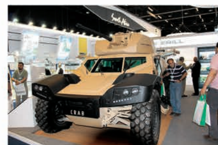
Внедорожник с танковой башней: бывает и такое! Бельгийская установка Cockerill на французском шасси Panhard
