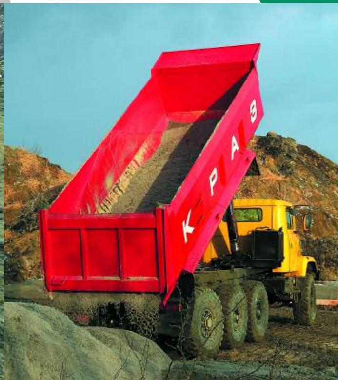
поворотов-разворотов подсознательно кажется, что машине потребуется значительно большее пространство. Благодаря тому, что управляемыми сделаны крайние оси, не возникает и эффекта «пуга» при крутом повороте на скользкой дороге (а в карьере, где мы проводили испытания, только такие и были): даже при задействованных задних межколёсных блокировках гружёный самосвал не стремится соскользнуть передними колёсами наружу поворота, потому как задняя ось стабильно «подкручивает» корму в нужном направлении.
