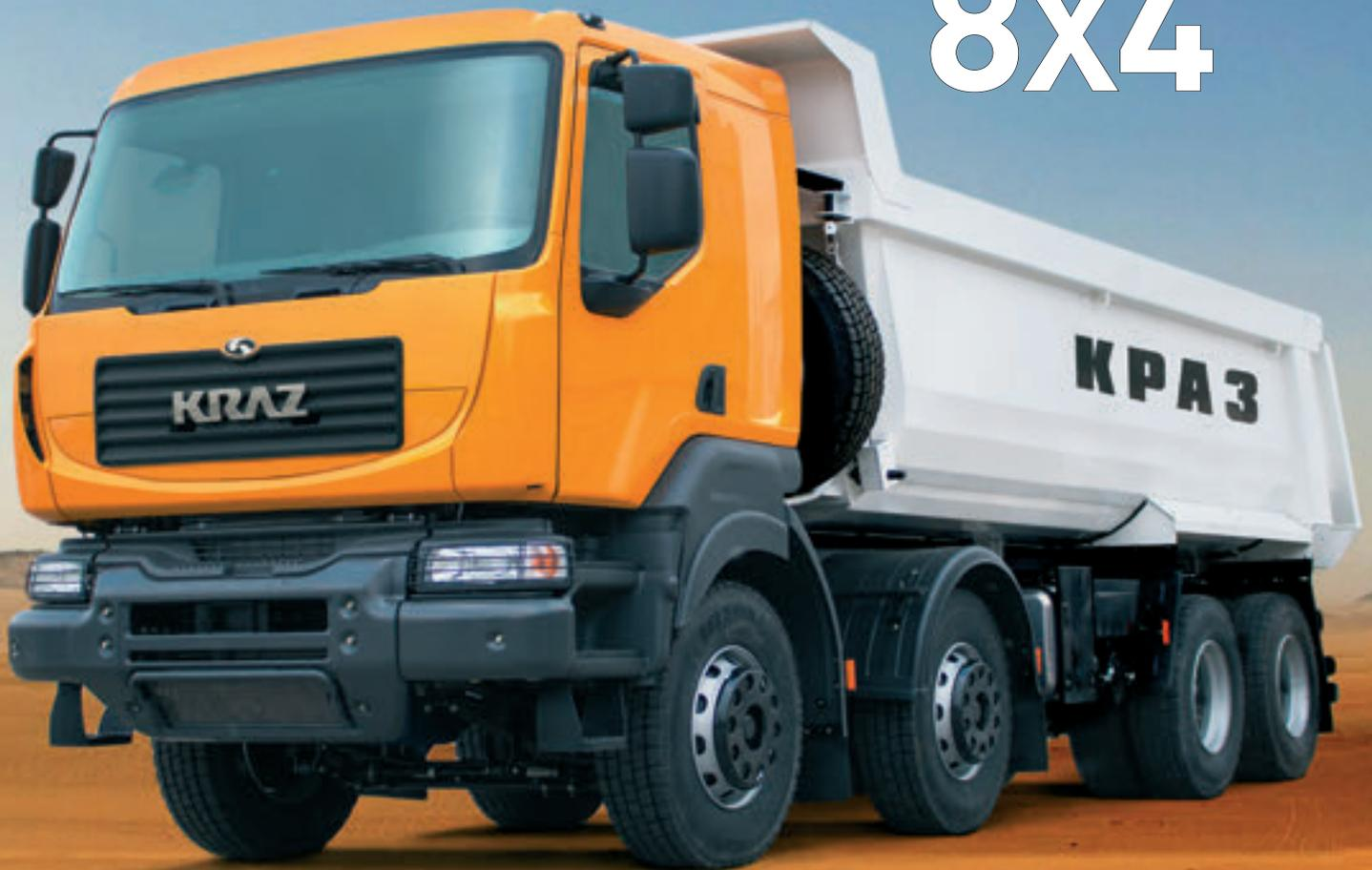
В канун Нового 2016 года состоялось прибавление в семействе кременчугских грузовиков. В модельном ряду автомобилей КРАЗ появился новый четырехосный самосвал в бескапотном исполнении КРАЗ-7133С4 колесной формулы 8x4. Он был создан согласно плану ОКР и НИР на 2015 год. Этот самосвал - самый могучий среди всех своих серийных собратьев. Он обладает улучшенными эксплуатационными характеристиками.
