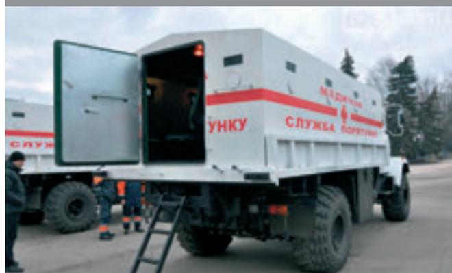
Бронированный автомобиль КрАЗ-5233BE (4x4) для безопасной эвакуации мирного населения
