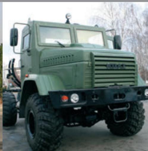
Бронированное шасси КрАЗ-5233NE (4x4) с двумя ведущими мостами
