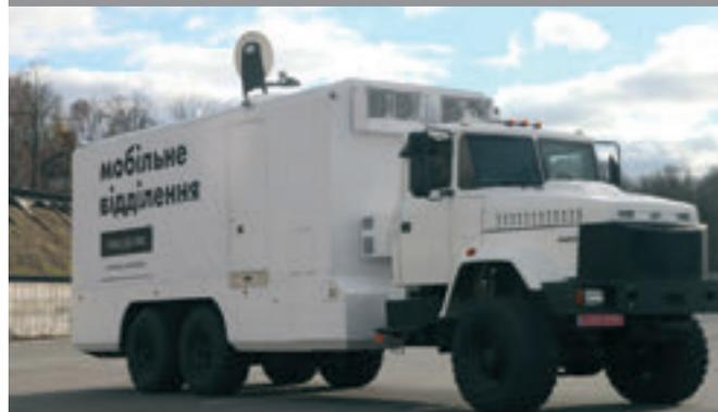
Бронированное мобильное банковское отделение на базе вездехода КрАЗ-6322 (6x6)
